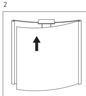
Nun kann die beschriftete Papiereinlage positioniert werden. Nach Einlage des Papiers die Abdeckung auf einer Seite einsetzen.
