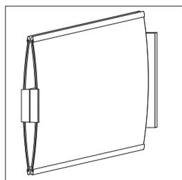
Die Montage erfolgt mittels zwei Schrauben, welche durch die seitlichen Bohrungen in die Wand verschraubt werden.
