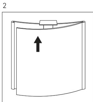
Nun wird das Türschild geschlossen, indem die Abdeckhaube auf der anderen Seite in das Profil einrastet. Abdeckkappen oben und unten in das Profil einführen.
