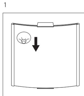
Die PVC-Haube entnehmen Sie, indem Sie den beiliegenden Sauger auf die Scheibe pressen und anschließend die Haube nach unten rausziehen.
