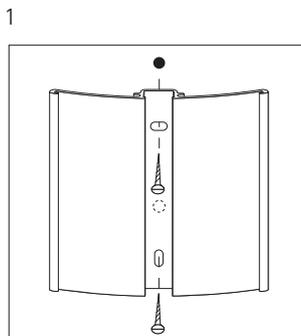
Das Türschild bzw. der Wegweiser wird mit zwei Schrauben an der Wand befestigt.
